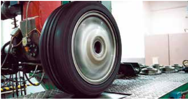
Reifen im Rollwiderstandstest
