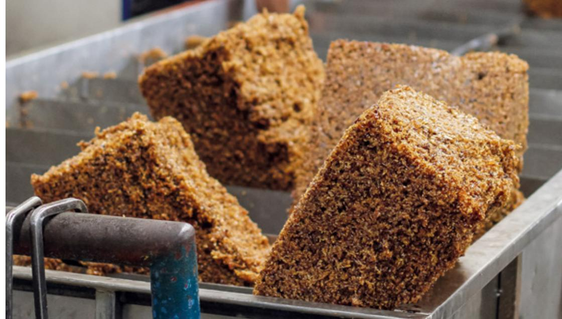
Crepe-Kautschuk (links) wird nur minimal verarbeitet und besteht im Wesentlichen aus flach gepresstem Cup-Lump-Kautschuk. Im Gegensatz dazu durchläuft TSR-Kautschuk (rechts) mehrere Verarbeitungsschritte: Der Cup-Lump-Kautschuk wird zunächst zerkleinert und gewaschen, bevor er zur weiteren Reinigung und Trocknung im Ofen auf über 100 °C erhitzt wird. Dabei werden auch Mikroorganismen und Keime weitgehend reduziert.
